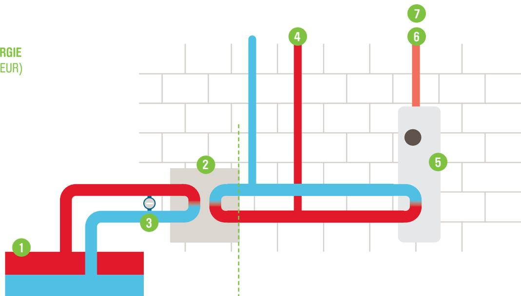
L'échangeur est propriété de Romande Energie. Les pertes quasi-inexistantes font que vous ne payez que votre consommation réelle. L'entretien de l'installation est assumé par Romande Energie jusqu'à la sortie de l'échangeur.
