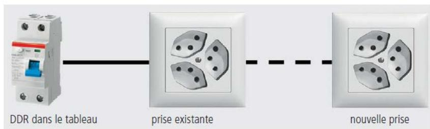
DDR dans l'ensemble d'appareillage lors d'un agrandissement dans le système TN-S.
